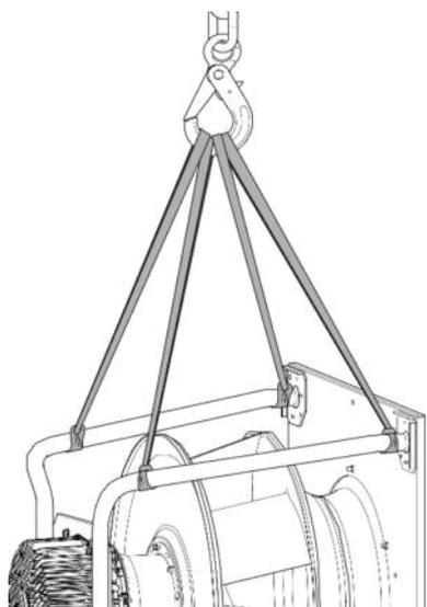
Abb. 1: Hebeskizze für den Transport des RadiPac
