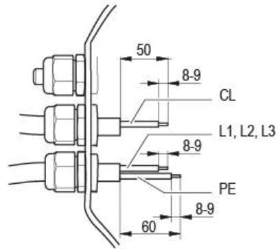
Abb. 2: Empfohlene Abmantelungslängen in mm (innerhalb Klemmkasten)
