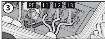
Abb. 3: Anschluss der Leitungen an Klemmen
